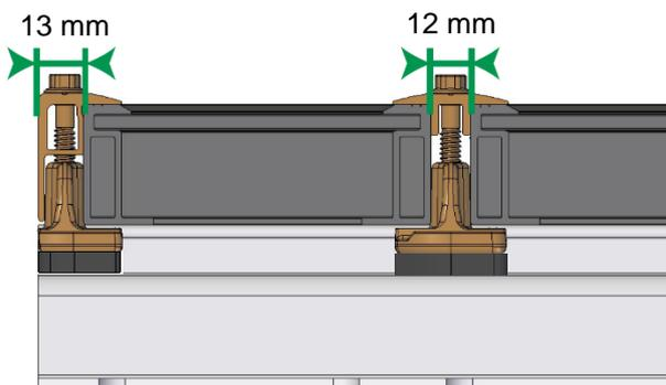
Endklemmenmontage bündig mit dem Schienenende möglich.
