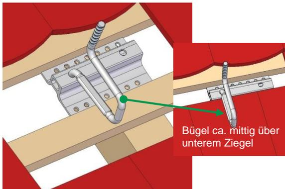
Einbau des Dachhakens mit dem langen Schenkel des Grundprofils nach unten. Position des Bügels unter Einhaltung des seitlichen Überstandes (MV 1.4) ca. mittig über dem darunter liegenden Ziegel.
