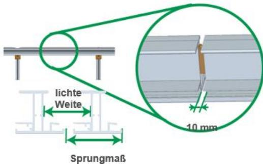
Einlegeschiene Plus auf C-Schienen mit Kreuzschienenverbinder-Set C ES wie Einlegeschiene befestigen. Verbinder Einlegeschiene Plus bis Anschlag einführen und zweite Schiene mit Abstand von 10 mm über den Schienenverbinder schieben.
