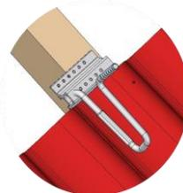
Dachhaken einlegen, sodass der Bügel im Wellental des Dachziegels liegt. Die Position des Dachhakens auf dem Sparren ist unter Berücksichtigung der statischen Vorgaben (MV 1.4) festzulegen.
