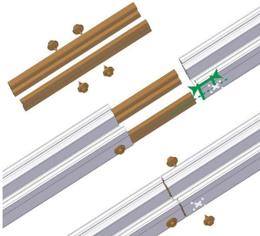
Schienenverbinder-Set (1) zur Hälfte in eine der zu verbindenden Schienen einschieben (2) und dort mit je einer Bohrschraube zu beiden Seiten mit ca. 20mm zum Schienenende fixieren. Anschließend die andere Schiene vollständig auf das Verbinders-Set schieben, so dass beide Schienenenden zusammenstoßen (3) und wie zuvor beschrieben abschrauben. Maximale Schienenlänge ohne Unterbrechung 13 m, danach echte Dehnfuge oder Loslager einbauen.
