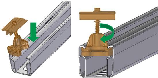
Mittel-bzw. Endklemmen an der Klemmstelle von oben in die Schienenkammer einführen. Anschließend die Schienenmutter in der Schiene drehen und Modulklemmen an den Modulrahmen anschieben.
