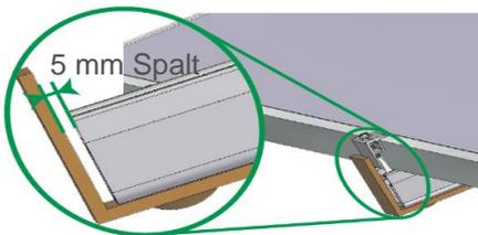
Abrutschsicherung am Schienenende mit ca. 5 mm Spalt mittels Befestigungsschraube und Sperrzahnmutter anschrauben.
