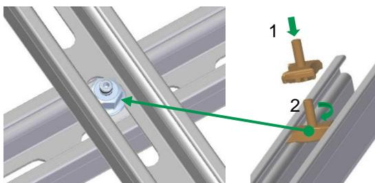
Kreuzschienenverbinder-Set C von oben in Schienennut einführen (1) und um  $90^\circ$  verdrehen (2).
