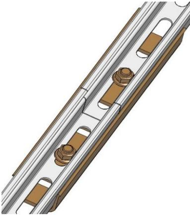
Schienenenden dicht stoßen, Schienenverbinder mittig anlegen und über die im Set enthaltenen Befestigungsschrauben mit der Schiene verbinden. Der Verbinder und die Anzahl Schrauben richten sich nach der Schiene (MV 3). Maximale Schienenlänge ohne Unterbrechung 13 m, danach Dehnfuge oder Loslager einbauen (MV 3.3).
