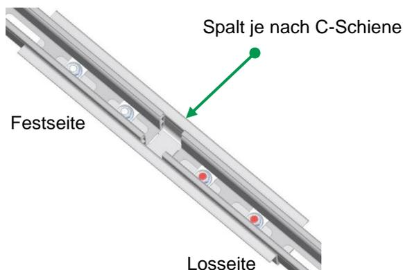
Schienenenden auf Spalt verlegen, Schienenverbinder anlegen und über die Befestigungsschrauben an der Fest- und Losseite mit der Schiene verbinden. Auf der Festseite sind die Schrauben fest anzuziehen. Auf der Losseite sind die Schrauben rot beschichtet und müssen nach dem Anziehen wieder gelöst werden (ca. 1/2 Umdrehung). Max. Schienenlänge mit Loslager 40 m, danach echte Dehnfuge einplanen.
