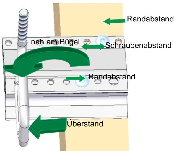
Der zulässige Überstand des Dachhakens über den Sparren ist der Projektstatik zu entnehmen. Die Holzschrauben sind mit dem größtmöglichen Schraubenabstand untereinander unter Einhaltung der Randabstände zum Sparren ohne Vorbohren einzudrehen. Dabei ist die Holzschraube in der Bügelachse so nah wie möglich am Bügel einzudrehen. Beim Dachhaken-Set BS gilt dies für die Holzschraube der oberen Schraubenachse. Für das Doppel-Dachhaken-Set gelten dieselben Vorgaben und sind sinngemäß anzuwenden.
