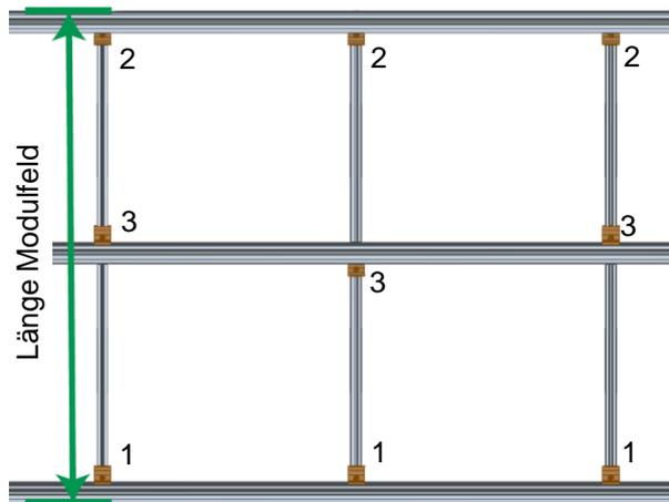
Bei der obersten und untersten Einlegeschiene des Modulfeldes wird das Kreuzschienenverbinder-Set C ES M8 jeweils auf der Innenseite montiert (1, 2), an den mittleren Einlegeschiene sind die Kreuzschienenverbinder-Set C ES M8 abwechselnd oben und unten am Halteflansch anzubringen (3)
