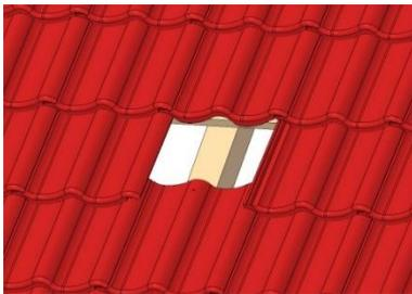
Freilegen der Sparren durch Ausbau der Ziegel.
