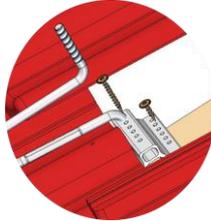
Befestigung der Dachhaken am Sparren mit Holzschrauben (MV 1.4). Die Schraubenlänge richtet sich nach dem Dachaufbau und wird von der Auslegungssoftware ermittelt. Falls die Konterlattung in der Auslegungssoftware nicht berücksichtigt wurde oder auf einer Aufsparrendämmung montiert wird, so ist das Grundprofil des Dachhakens beidseits der Konterlatte mindestens auf die Sparrenbreite zu unterfüttern.
