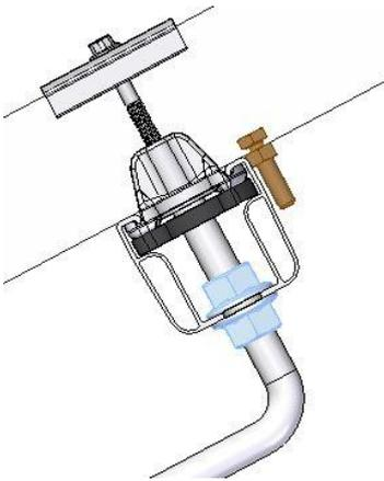
Vor der Modulmontage sind über der unteren Schienenlage die Abrutschsicherungen an den Rahmenbohrungen zu montieren (MV 4). Zur Erleichterung der Modulmontage wird der Einsatz der Abrutschsicherung an allen Modulen empfohlen.
