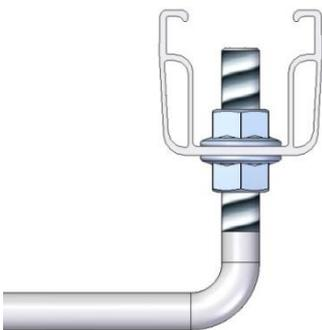
Auflegen der C-Schiene auf die untere Sperrzahnmutter, Schiene ausrichten und mit der oberen Sperrzahnmutter anziehen. Der Anschluss des Dachhakens kann auch am Schienenverbinder im Stoßbereich erfolgen. Bei der Montage im Kreuzschienenverband (Einlege-/Klemmsystem) erfolgt die Befestigung der oberen Schiene mittels Kreuzschienenverbinder bzw. Kreuzschienenverbinder-Set C ES M8 (MV 2).
