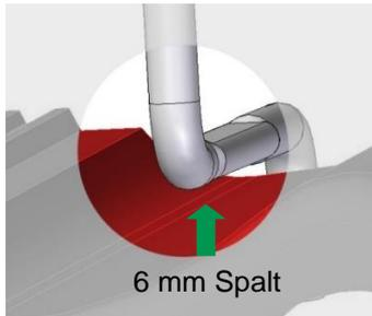
Höheneinstellung der Dachhaken über das Gewinde im Grundprofil. Der Abstand zwischen unterem Ziegel und Bügel muss nach der Befestigung 6 mm betragen.
