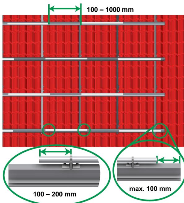
Abstand Alu-Rundrohr am Ende der Einlegeschiene im Anlageneckbereich max. 100 mm Abstand zwischen Rundrohren mind. 100 mm und max. 1000 mm.
