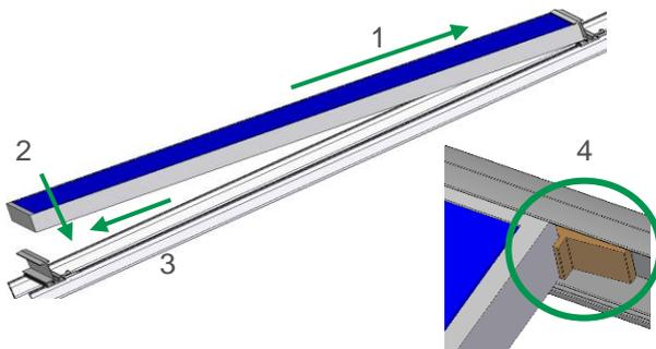
Modul auf die obere Einlegeschiene aufsetzen und nach oben schieben (1). Danach das Modul auf die untere Einlegeschiene absetzen (2) und nach unten gegen die Einlegeschiene ziehen (3). Folgemodule nach demselben Prinzip montieren, der Spalt zwischen den Modulen muss mind. 3 mm betragen.
