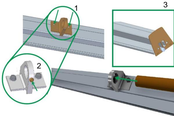
Die Halter sind mit zwei Bohrschrauben (1) auf die Einlegeschiene Plus zu befestigen. Rundrohre mittig positionieren und mit der Madenschraube fixieren (2).
