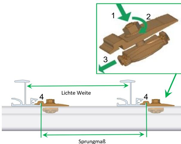
Kreuzschienenverbinder-Set C ES M8 von oben in die Schienenrinne einführen (1), Mutter um 90° verdrehen (2) und Bauteil gegen die Einlegeschiene schieben (3), so dass das Kreuzschienenverbinder-Set C ES M8 sich mit dem Halteflansch verriegelt (4).
