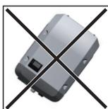
No montar el inversor en una posición inclinada en una columna o pared vertical.
