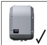
El inversor resulta adecuado para el montaje vertical en una columna o pared vertical.
