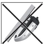
No montar el inversor con una inclinación unilateral con las conexiones orientadas hacia arriba.
