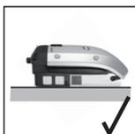
El inversor resulta adecuado para una posición de montaje horizontal.
