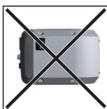
No montar el inversor en una posición horizontal en una columna o pared vertical.
