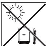
Para que el inversor se caliente lo menos posible, no debe exponerse a la radiación solar directa. Lo ideal es montar el inversor en una posición protegida, por ejemplo, en la zona de los módulos solares o debajo de un saliente de tejado.
