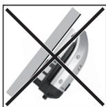
No montar el inversor con una inclinación unilateral con las conexiones orientadas hacia abajo.
