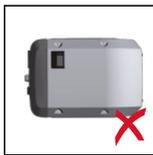
No montar el inversor en horizontal sobre una columna o pared vertical.
