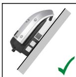
El inversor resulta adecuado para el montaje sobre una superficie inclinada.
