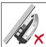
No montar el inversor con un lado inclinado y las conexiones orientadas hacia abajo.
