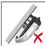
No montar el inversor con un lado inclinado y las conexiones orientadas hacia arriba.
