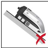
No montar el inversor sobre una superficie inclinada con las conexiones orientadas hacia arriba.
