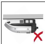
Den Wechselrichter nicht an der Decke montieren.
