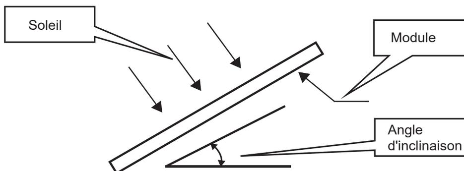
Il vaut mieux que les modules soient orientés au sud dans l'hémisphère nord et orientés au nord dans l'hémisphère sud. Veuillez vous référer au manuel d'installation des modules standard ou aux suggestions d'un installateur expérimenté de modules PV pour l'angle d'installation spécifique.
