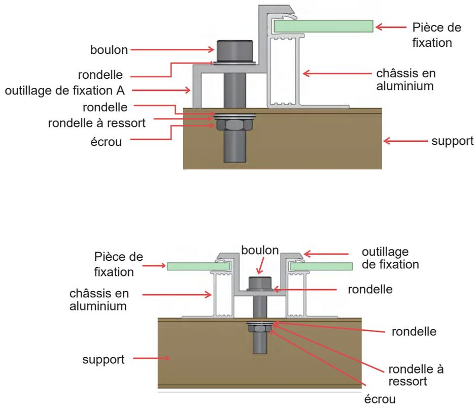
Figure 5 Installation du module monofacial par boulon
