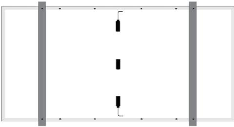
Installation avec des boulons à 4 trous extérieurs
