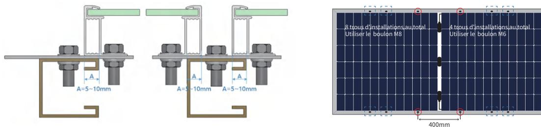
Figure 7 Installation du module bifacial par boulon
