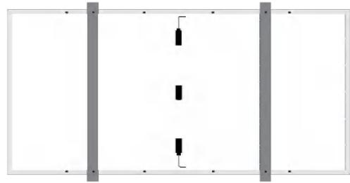
Installation avec des boulons à 4 trous intérieurs
