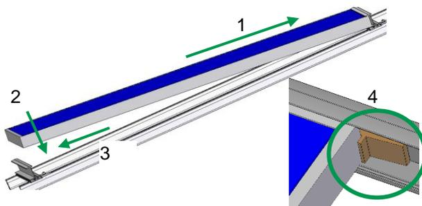
Modul auf die obere Einlegeschiene aufsetzen und nach oben schieben (1). Danach das Modul auf die untere Einlegeschiene absetzen (2) und nach unten gegen die Einlegeschiene schieben (3). Folgemodule nach demselben Prinzip montieren, der Spalt zwischen den Modulen muss mind. 3 mm betragen.
