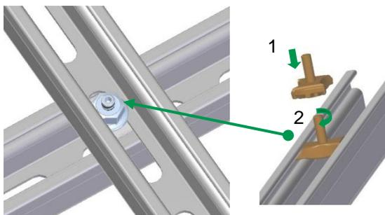
Kreuzschienenverbinder-Set C von oben in Schienennut einföhren (1) und um 90° verdrehen (2).
