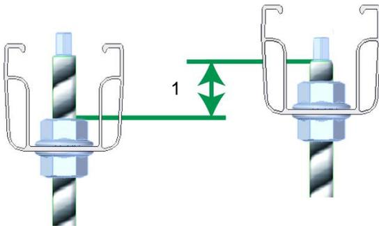
C-Schiene auf die untere Sperrzahnmutter auflegen, Höhe der Schiene durch entsprechendes positionieren der Sperrzahnmutter verstellen (1). Anschließend obere Sperrzahnmutter anziehen. Anschluss der Stockschraube auch am Schienenverbinder im Stoßbereich möglich.
