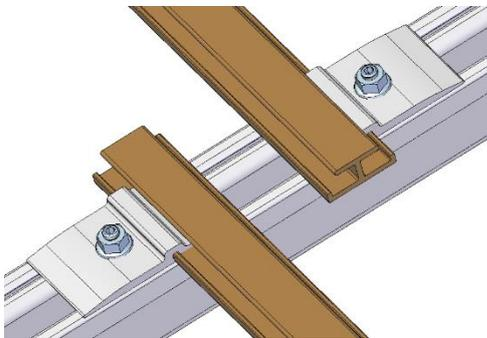
Stützschiene ES mit der Kreuzschienenverbinder-Set C ES befestigen - die Stützschiene sind parallel zu den Einlegeschiene zu montieren und im Überlappungsbereich auf der C-Schiene versetzt anzuordnen.
