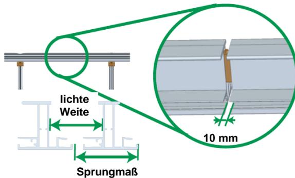
Einlegeschiene Plus auf C-Schienen mit Kreuzschienenverbinder-Set C ES M8 wie Einlegeschiene befestigen. Verbinder Einlegeschiene Plus bis Anschlag einführen und zweite Schiene mit Abstand von 10 mm über den Schienenverbinder schieben.
