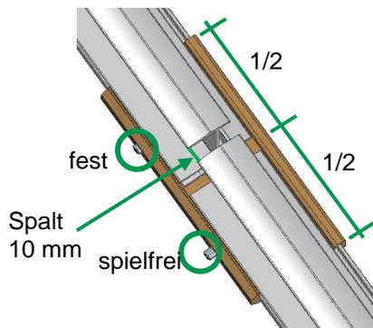
Schienenverbinder über montierte Schiene mittig schieben und ersten Gewindestift fest anziehen. Anzuschließende Schiene in den Verbinder einschieben. Spalt zwischen den Schienen 10 mm, zweiten Gewindestift spielfrei anziehen. Für die Montage der Einlegeschiene Plus ist MV 7 zu beachten.
