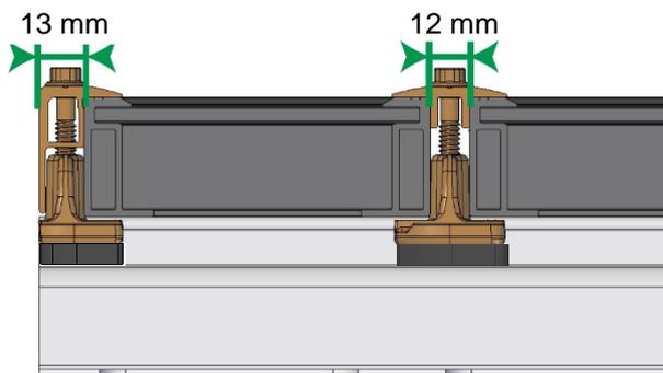
Endklemmenmontage bündig mit dem Schienenende möglich.
