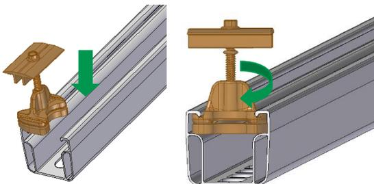
Mittelklemmen bzw. Endklemmen an der Klemmstelle von oben in die Schienenkammer einföhren. Anschließend die Schienenmutter in der Schiene drehen und Modulklemmen an den Modulrahmen anschieben.
