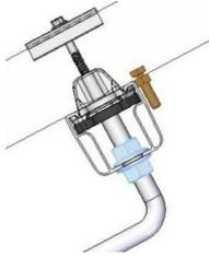
Vor der Modulmontage sind über der unteren Schienenlage die Abrutschsicherungen an den Rahmenbohrungen zu montieren. Zur Erleichterung der Modulmontage wird der Einsatz der Abrutschsicherung an allen Modulen empfohlen.
