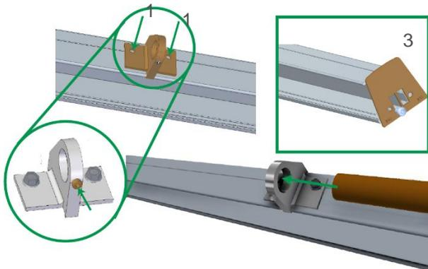
Die Halter sind mit zwei Bohrschrauben (1) auf die Einlegeschiene Plus zu befestigen. Rundrohre mittig positionieren und mit der Madenschraube fixieren (2).
