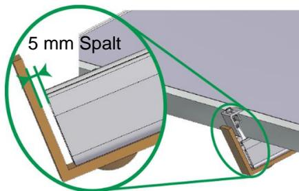
Vor der Modulmontage Abrutschsicherung am Schienenende mit ca. 5 mm Spalt mittels Befestigungsschraube und Sperrzahnmutter anschrauben (MV 6.1/6.2).
