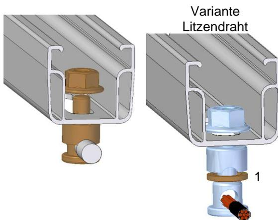
Erdungsdraht ( $\varnothing$  gem. nationalen Vorgaben): Erdungsverbinder demontieren, Klemmscheibe entfernen (1). Bauteil von unten durch das Langloch der C-Schiene schieben. Erdungsdraht durch die Öffnung (geeignet für  $\varnothing$  6-10 mm) schieben und Bauteil mit der Sperrzahnmutter am Schienenboden befestigen.
