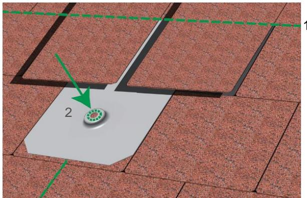
Falls erforderlich darüberliegende Schindeln lösen, Metallschindel bündig bis zur oberen Kante der darunterliegenden Dachschindelreihe schieben (1) und ausrichten. Anschließend durch Loch (d= 14 mm) in der Metallschindel Position der Stockschraube anzeichnen (2) und Sparren durch die Dacheindeckung entsprechend der Stockschraubengröße vorbohren (MV 1).
