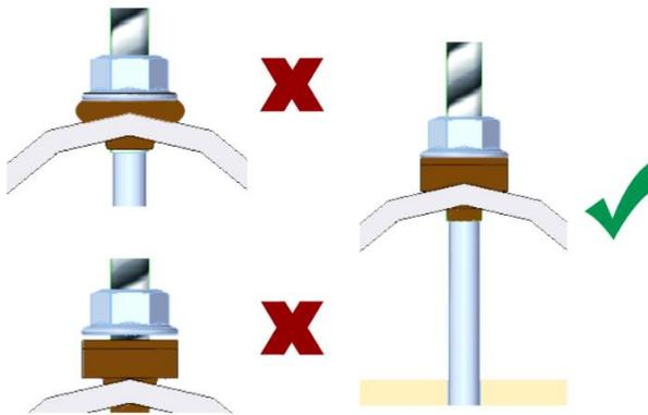
Untere Sperrzahnmutter anziehen, bis EPDM-Dichtung leicht komprimiert wird – der Konus der Dichtung taucht in das vorgebohrte Loch der Dacheindeckung ein.
