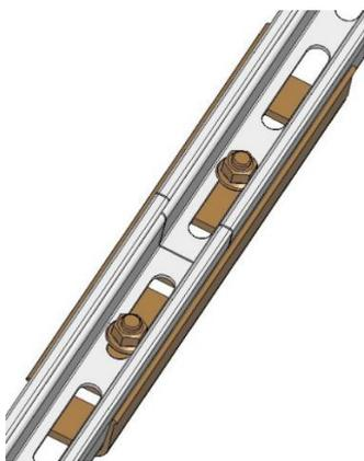
Schienenenden dicht stoßen. Schienenverbinder mittig anlegen und über die im Set enthaltenen Befestigungsschrauben mit der Schiene verbinden. Der Verbinder und die Anzahl Schrauben richten sich nach der Schiene (MV 3).
