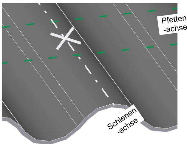
Achse der Montageschienen auf den Wellenbergen / Hochsicken anzeichnen. Position Stockschrauben entlang der Schienenachsen über den Pfetten markieren.
