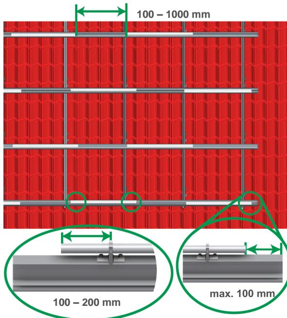
Abstand Alu-Rundrohr zum Ende der Einlegeschiene im Anlageneckbereich max. 100 mm. Abstand zwischen Rundrohren mind. 100 und max. 1000 mm.
