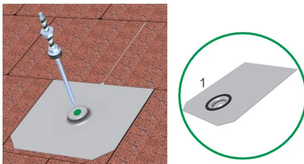
Erhebung der Metallschindel über der Bohrung positionieren und Stockschraube eindrehen.
