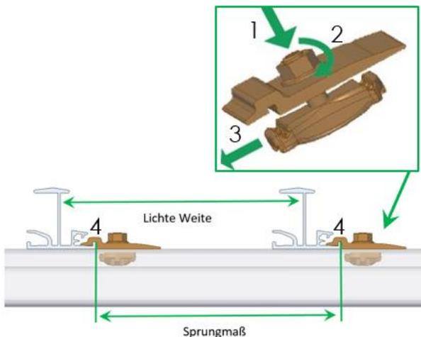
Kreuzschienenverbinder-Set C ES M8 von oben in Schienennut einführen (1). Mutter um 90° verdrehen (2) und Bauteil gegen die Einlegeschiene schieben (3), so dass das Kreuzschienenverbinder-Set C ES M8 sich mit dem Halteflansch verriegelt (4).
