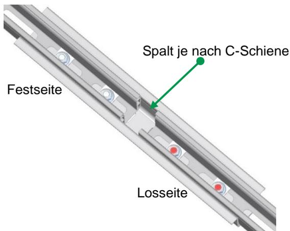
Schienenenden auf Spalt verlegen, Schienenverbinder anlegen und über die Befestigungsschrauben an der Fest- und Losseite mit der Schiene verbinden. Auf der Festseite sind die Schrauben fest anzuziehen. Auf der Losseite sind die Schrauben rot beschichtet und müssen nach dem Anziehen wieder gelöst werden (ca.  $\frac{1}{2}$  Umdrehung). Max. Schienenlänge mit Loslager 40 m, danach echte Dehnfuge einplanen.
