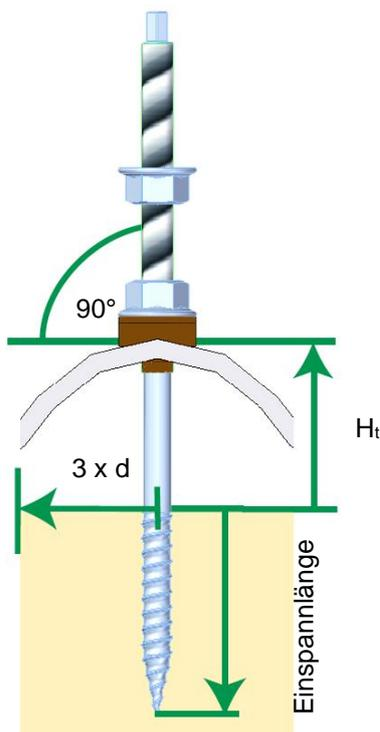
Holzpfetten durch die Dacheindeckung vorbohren, danach Dacheindeckung aufbohren. Anschließend Stockschrauben senkrecht in die Pfette eindrehen.
