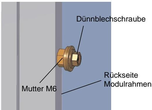
Mutter über die Schraube schieben und Dünnschraube ohne Vorbohren in den Modulrahmen eindrehen.
