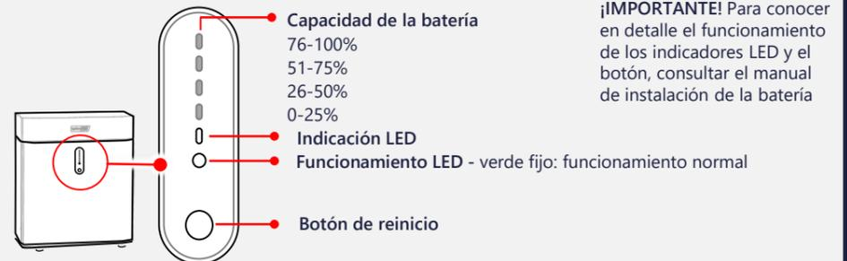
**¡IMPORTANTE!** Para conocer en detalle el funcionamiento de los indicadores LED y el botón, consultar el manual de instalación de la batería
