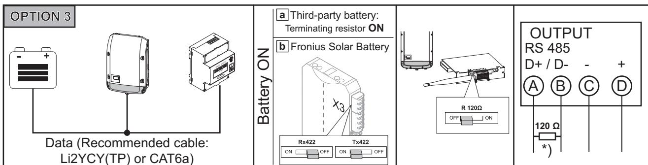
**DE** \*) Abschlusswiderstand R 120 Ohm liegt beim Fronius Smart Meter bei
