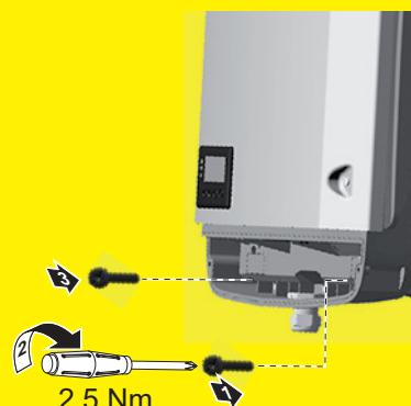
Atornillar el inversor siempre mediante los tornillos de fijación firmemente al soporte de montaje, según el par indicado en el manual de instrucciones.
