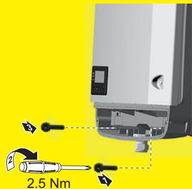
Az invertert mindenkor rögzítőcsavarokkal, a kezelési útmutatóban megadott nyomatékkal a tartószerkezethez.
