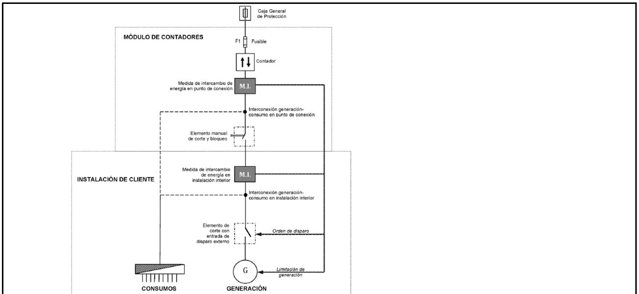
Figura 1 – Esquema con medida de intercambio de energía en instalaciones conectadas a redes de baja tensión
