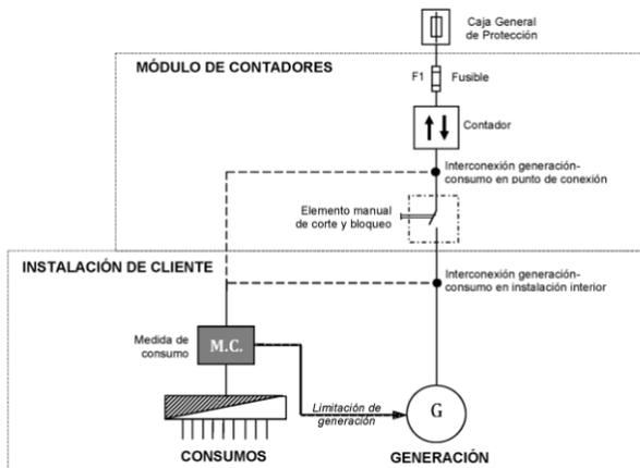
Figura 3 – Esquema con medida de consumo de energía en instalaciones conectadas a redes de baja tensión
