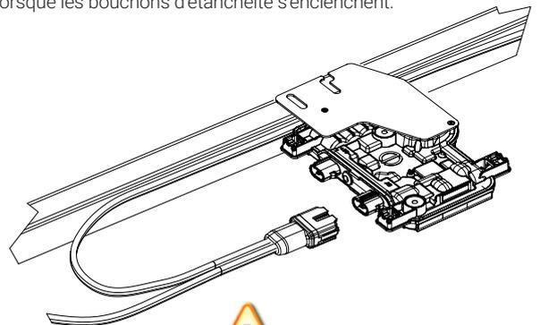
**AVERTISSEMENT** : installez des bouchons d'étanchéité sur tous les connecteurs AC inutilisés, qui sont sous tension lorsque le système est en service. Les bouchons d'étanchéité sont indispensables pour une protection contre la pénétration d'humidité.
