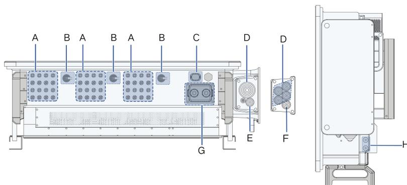
**figure 5-1** Terminal Description(SG125/110CX-P2)
