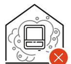
Fondamentalmente l'inverter è realizzato a tenuta di polvere (IP66). Tuttavia, nelle aree che presentano forti accumuli di polvere, le superfici di raffreddamento possono impolverarsi compromettendo così l'efficienza termica. In questo caso è necessaria una pulizia a intervalli regolari. È pertanto sconsigliato il montaggio in locali e ambienti caratterizzati da un massiccio sviluppo di polveri.
