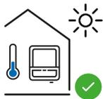
Montare l'inverter in una posizione riparata, ad es. al di sotto dei moduli solari o sotto una sporgenza del tetto.
