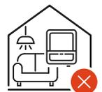
Dato che l'inverter in determinate condizioni di funzionamento può emettere una lieve rumorosità, non montarlo nelle immediate vicinanze di locali ad uso abitativo.
