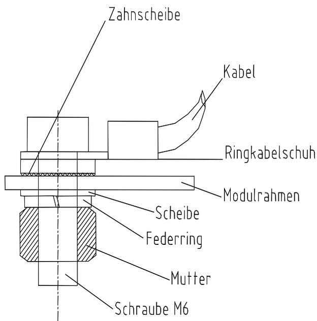
Die Erdung der Solarmodule ist entsprechend den landesspezifischen Vorgaben und Gesetzen umzusetzen. Ist auf dem Gebäude bereits ein Blitzschutzsystem vorhanden oder vorgesehen, muss die PV-Anlage in das Schutzkonzept gegen direkten Blitzeinschlag integriert werden. Bei Verwendung eines trafolosen Wechselrichters kann ein Potentialausgleich entsprechend den Angaben des Wechselrichter-Herstellers vorgeschrieben sein. Landesspezifische Gesetze sind einzuhalten.
