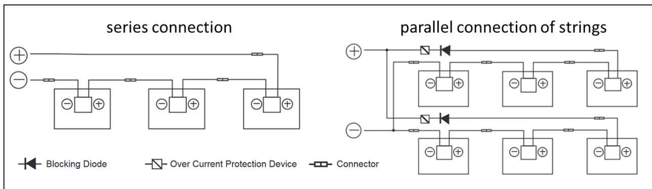
Für die parallele Verschaltung der Solarmodule werden geeignete Maßnahmen zum Überstromschutz (z.B. Strangsicherung) benötigt. Es ist darauf zu achten, dass die angegebene Belastbarkeit bezüglich des Rückstroms gemäß Datenblatt nicht überschritten wird. Bei mehr als zwei parallelen Strängen müssen Strangsicherungen und Strangdioden verwendet werden.
