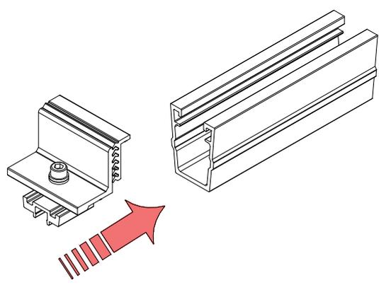
Introducir la parte inferior del presor en el perfil G48 y alinear salientes del presor en la ranura del perfil.
