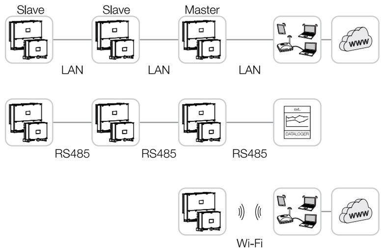
Der Wechselrichter PIKO CI besitzt Schnittstellen für LAN, RS485 Modbus und WiFi. So bestehen verschiedene Möglichkeiten, einen oder mehrere Wechselrichter miteinander zu vernetzen und zu steuern.
