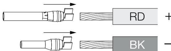
3. Crimpen Sie den Kontakt mit einer passenden Crimpzange.
