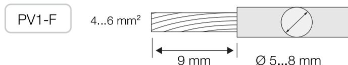
2. Führen Sie das abisolierte Leitungsende in den Crimphals des Kontakts ein.
