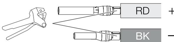
4. Führen Sie den Kontakt in den Steckverbinder ein, bis der Kontakt mit einem fühl- und hörbaren Klick einrastet.
