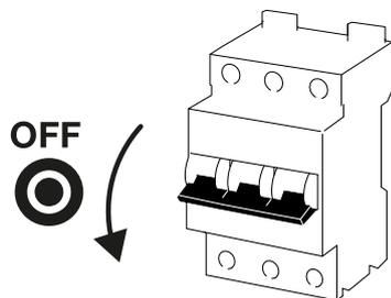
2. DC-Schalter am Wechselrichter auf **OFF** stellen.
