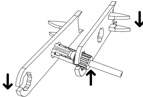
✓ PV-Steckverbinder montiert
