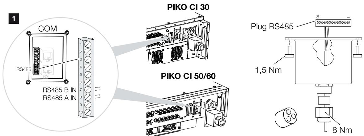
5. Das Kommunikationskabel an den Steckverbinder für die Kommunikationsschnittstelle anschließen. Pinbelegung beachten. Anzugsdrehmoment: 0,2 Nm.
