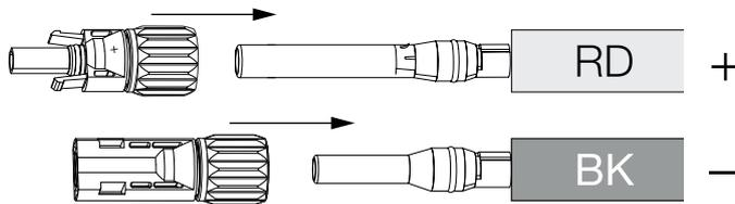
5. Ziehen Sie die Mutter am Steckverbinder an (3 Nm).
